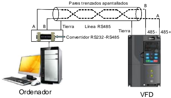
Figura 9-1 Cableado de una aplicación RS485 para VFD
