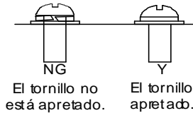
Figura 4-34 Instalación de los tornillos
