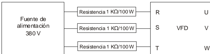
Figura 8-4 Ejemplo de circuito de conducción-carga de 380 V
