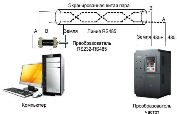
Рис. 10-1 Физическая схема подключения для автономного использования RS485
