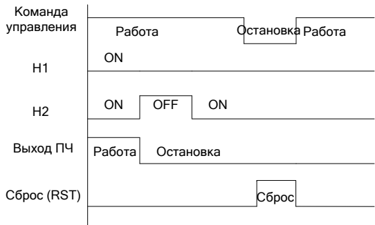
Рис. А-23 Логическая схема с нарушением цепи безопасности 2
